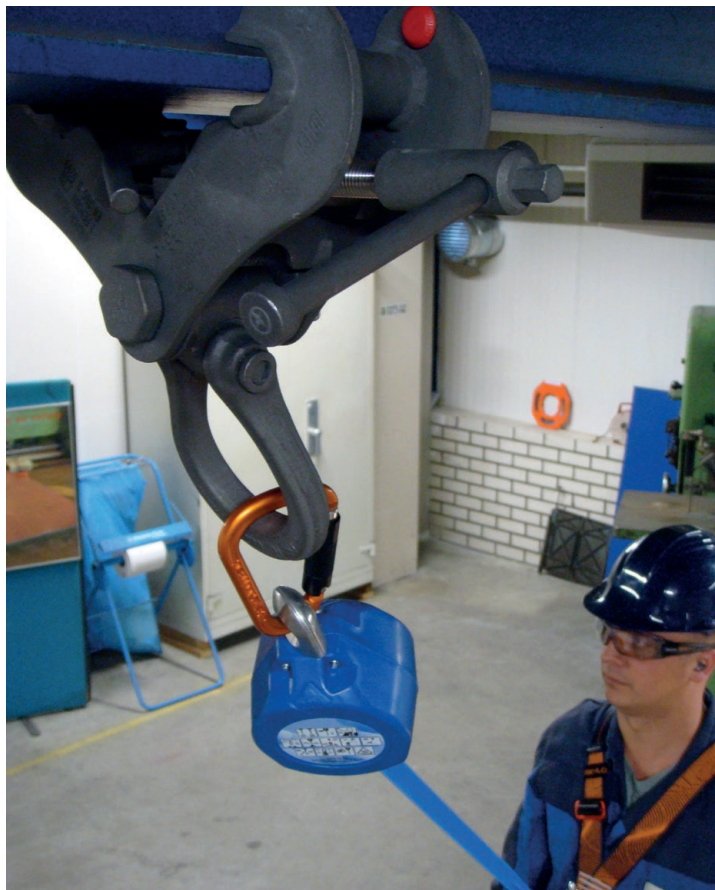
IPTKUM für PSA - Anschlagpunkt nach EN795
